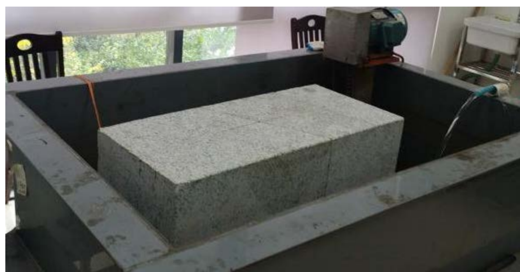
含倾斜裂缝缩尺模型井声波测井模拟实验系统(左)及实验得到的归一化斯通利波衰减系数随裂缝宽度变化曲线(右)
